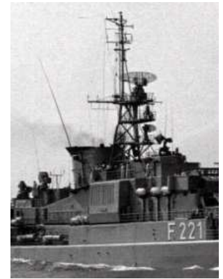
Umgebaute, gerade Turbinenansaugschächte Ansicht ab 1967
