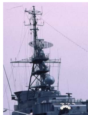
Modifizierte Radarantennen, Antenne oberhalb der Brücke entfernt, Radarantenne über Hullnummer für Navigationsradar KH14/9 hinzu, Teilüberdachung der Brücke hinzu, ab 1980 IFF-Antenne hinzu. Ansicht von 1978 - 1983
