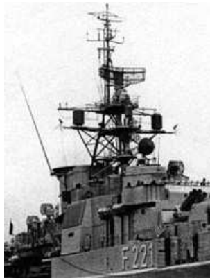
Erstausrüstung der Sensorelektronik, schräge Turbinenansaugschächte, Ansicht von 1961 - 1965
